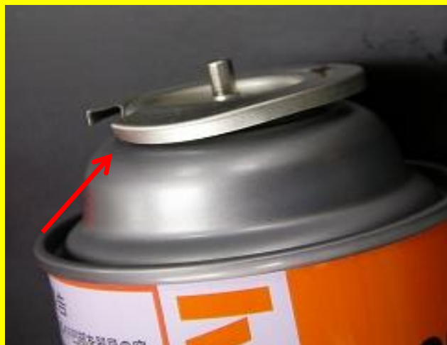
変形やゆがみが生じているもの
