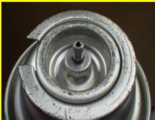
ボンベ先端部分にサビが出ているもの
