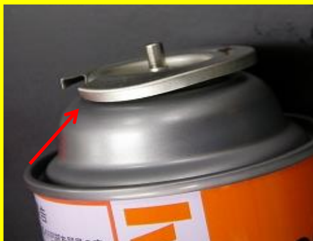
変形やゆがみが生じているもの
