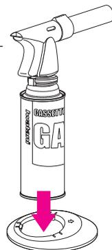
容器(ボンベ)を装着後、装着部より「シュー」というガスの漏れる音やガス臭がするときは、容器(ボンベ)を取り外し、接合部に付着したゴミを取り除いてください。ガス漏れが止まらない場合は使用を中止し、お買い求めの販売店に修理を依頼してください。
